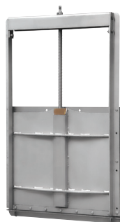
Serie 772/61 Muraafsluiter Dubbelzijdige afdichting t.e.m. 1200 x 1200 mm, in grotere afmetingen enkel- of dubbelzijdige afdichting Met niet-stijgende spindel uit roestvast staal AISI 304 200 x 200 mm - 2000 x 2000 mm Bidirectioneel
