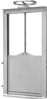
Serie 772/61 Kanaalafsluiter Enkelzijdige afdichting t.e.m. 1000 x 1000 mm, in grotere afmetingen enkel- of dubbelzijdige afdichting Met niet-stijgende spindel uit roestvast staal AISI 304 200 x 200 mm - 2000 x 2000 mm Unidirectioneel
