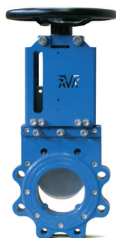
Serie 702/10 Mesafsluiter met niet-stijgende spindel en handwiel NBR-rubber Nodulair gietijzer DN 50-1200
