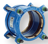
Serie 621/10 Supa Plus™ rechte koppeling Trekvast voor PE en uPVC buizen Nodulair gietijzer DN 32-300 PN 16
