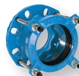
Serie 603 Supa® flensadapter universeel voor uPVC, vezelcement, staal, grijs en nodulaire gietijzeren buizen Universele boring Nodulair gietijzer DN 40-400 PN 10/16
