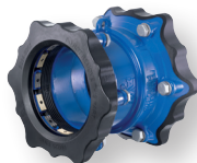
Serie 632 Supa Maxi™ verloopkoppeling Universeel en trekvast voor alle buizen Nodulair gietijzer DN 50-300 PN 16
