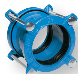
Serie 601 Supa® rechte koppeling universeel voor uPVC, vezelcement, staal, grijs en nodulaire gietijzeren buizen Nodulair gietijzer DN 40-400 PN 16
