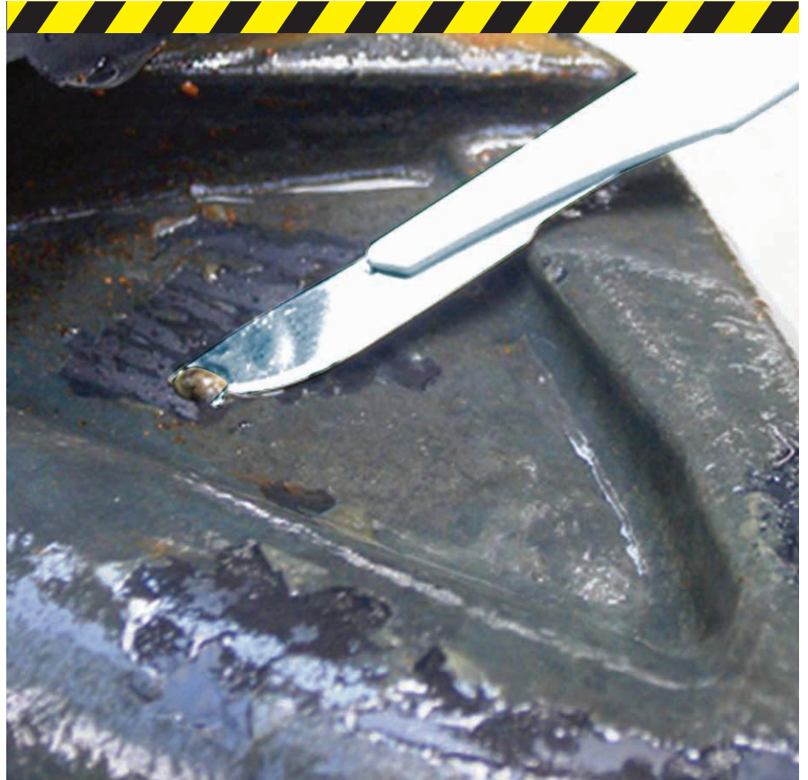
EPDM-schuif van een ander merk na zes maanden - een mooi voorbeeld van microbiologische groei op een foutief geformuleerde rubber compound.
