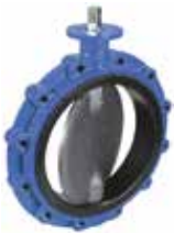
Serie 75/41 Vlinderklep Centrisch met vaste voering Full lug type DN 50-1200 PN 10/16 Nodulair gietijzer
