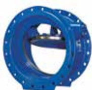
Serie 875 Scharnierende terugslagklep Roestvaststalen dichting Hendel met verstelbaar gewicht DN 150-1600 PN 10/16 Nodulair gietijzer
