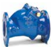
Serie 41/61 Scharnierende terugslagklep Zacht dichtend Gesloten busen DN 50-300 PN 10/16 Nodulair gietijzer
