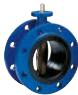
Serie 75/20 Vlinderklep Centrisch met vaste voering Dubbel geflensd kort DN 50-2000 PN 10/16 Nodulair gietijzer
