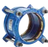
Serie 621/10 Supa Plus™ rechte koppeling Trekvast voor PE- en uPVC-buizen Nodulair gietijzer DN 32-300 PN 16
