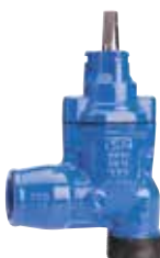
Serie 11/30 Haakse dienstkraan met buitenschroefdraad en trekvast mofeind voor PE-buizen DN 25-50 PN 16 Nodulair gietijzer
