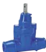
Serie 03/30 Dienstkraan met trekvast mofuiteinden voor PE-buizen DN 20-50 PN 16 Nodulair gietijzer
