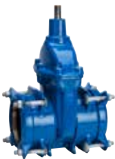
Serie 01/70 Supa Plus™ schuifafsluiter Trekvaste koppeling-uiteinden voor PE- en uPVC-buizen DN 40-300 PN 16 Nodulair gietijzer
