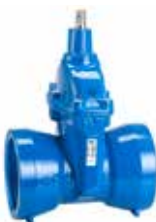
Serie 33/10 Schuifafsluiter met tytoneinden voor gietijzeren buizen DN 80-300 PN 16 Nodulair gietijzer Met interne emaille
