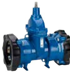
Serie 636/00 Supa Maxi™ schuifafsluiter Universeel en trekvast voor alle buistypes Nodulair gietijzer DN 80-300 PN 16
