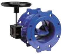
Serie 756 Vlinderklep Dubbel excentrisch Dubbel geflensd Geïntegreerde zitting IP 67 reductiekast DN 200-2800 PN 10/16 Nodulair gietijzer
