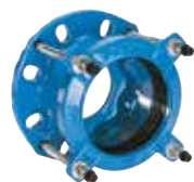
Serie 603 Supa® universele flensadapter voor uPVC, AC, stalen, gietijzeren en nodulair gietijzeren buizen Nodulair gietijzer DN 40-400 PN 10/16
