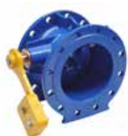
Serie 874 Scharnierende terugslagklep Zacht dichtend Hendel met verstelbaar gewicht DN 150-1600 PN 10/16 Nodulair gietijzer
