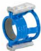
Serie 712 Trekvaste klem voor PVC- buizen DN 80-200 90-225 mm PN 16
